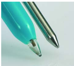
pH2 наконечник зонда для полутвердых субстанций
