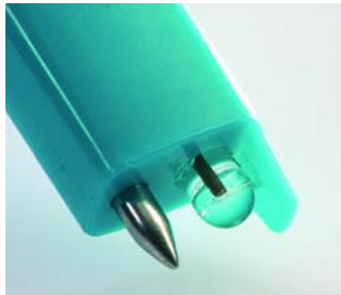
pH1 наконечник зонда для жидкостей
