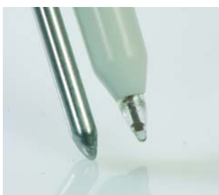
pH наконечник, вставленный в прочный пластик
