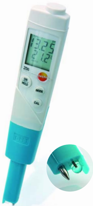
pH1 наконечник зонда для жидкостей
