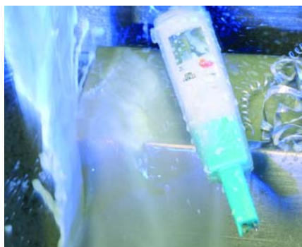
Чехол TopSafe защищает даже в промышленных условиях
