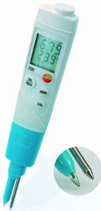
pH2 наконечник зонда для полутвердых субстанций
