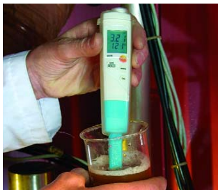
testo 206-pH1 идеален для измерений в жидкостях
