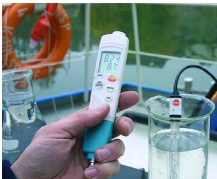
Автоматическая температурная компенсация во внешних зондах с сенсором температуры
