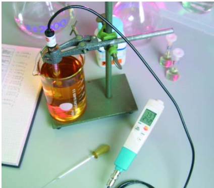
testo 206-pH3 обеспечивает подсоединение внешних зондов
